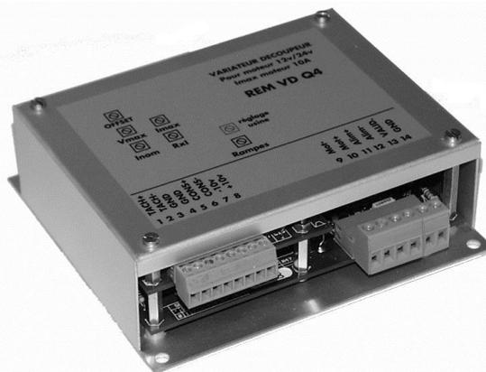
Le REM VDQ4 permet l'asservissement de la vitesse de moteurs à courant continu dans les quatre quadrants : accélération et freinage dans les deux sens de rotation. Idéal dans une boucle d'asservissement de position, ce variateur permet trois modes de fonctionnement : asservissement induit, tachymétrique ou couple.
