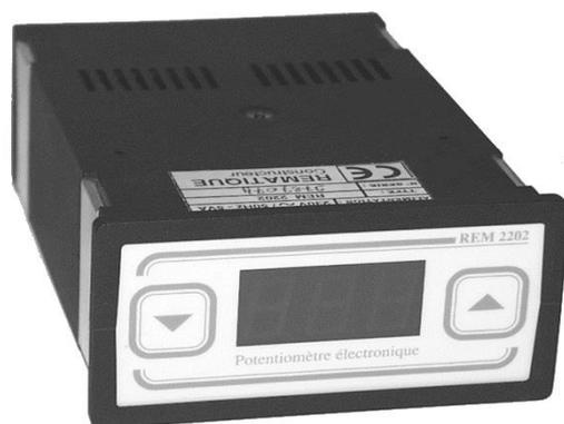
Le REM 2202 remplace avantageusement un potentiomètre motorisé pour la commande de variateurs de vitesse (à partir de points différents) même pour les applications nécessitant une grande précision. Résolution 1000 pas.
